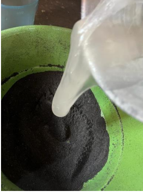
Gambar 5. Pencampuran serbuk arang kulit siwalan dengan perekat
