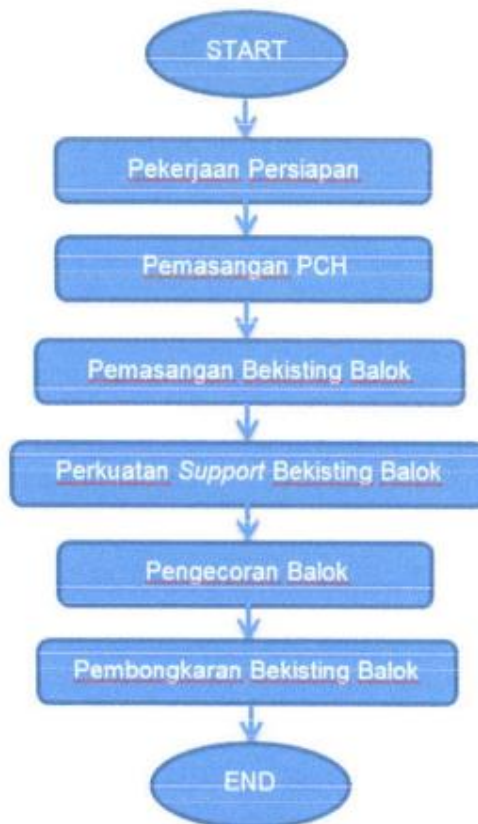
Gambar 3.60 Formwork Pekerjaan Balok dan Pelat Lantai
