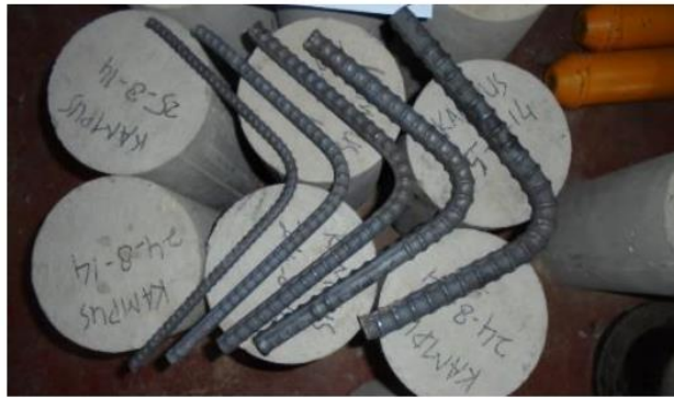
Gambar 3.106 Uji Lengkung Baja Tulangan
