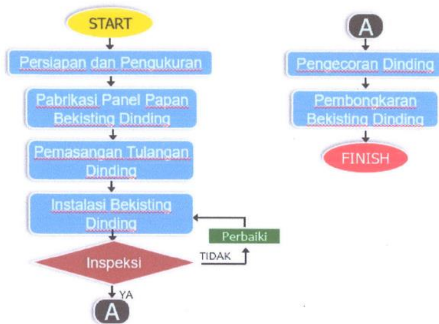
Gambar 3.75 Flowchart Pekerjaan Shear Wall
