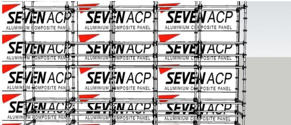
Gambar 3.93 Pemasangan ACP Sesuai Pola
